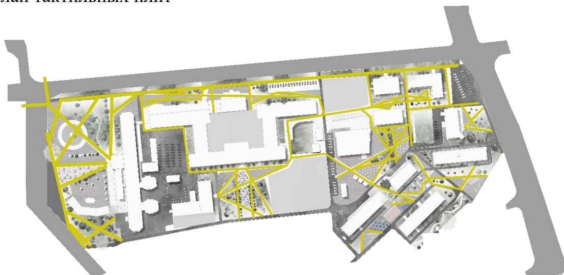
Рисунок 20 – план тактильных плит (чертеж автора)
